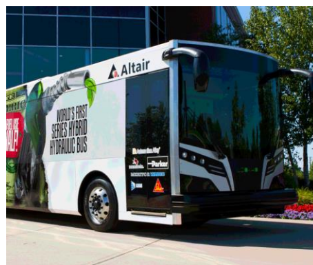
Figur 14. Altair hydraulisk hybridbuss (serietyp)
